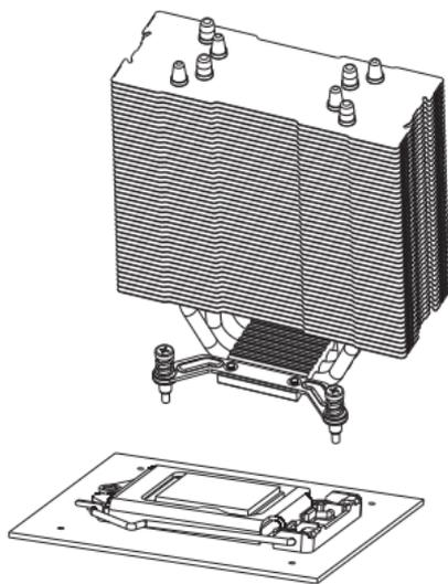
1. Ajuste os 4 parafusos nos furos da placa mãe, e suporte plástico **C**;
