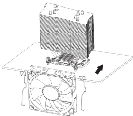
Passo 5: Conecte o fan a porta CPU-FAN da placa mãe e pronto. Instalação concluída com sucesso.
