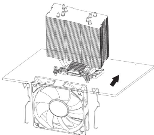
**Passo 7: Conecte o fan a porta CPU-FAN da placa mãe e pronto. Instalação concluída com sucesso.**
